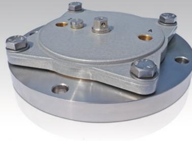
Mit dem Druckmessumformer 1:1 Typ 931 kann der Druck von flüssigen, hochviskosen oder aggressiven Medien in ein pneumatisches Signal umgewandelt werden, das z.B. einem pneumatischen Messwerkregler zugeführt wird. Der Druckmessumformer ist äusserst einfach und robust aufgebaut und arbeitet wartungsfrei. Der Druckmessumformer Typ 931 wird überall dort eingesetzt, wo der Druck von aggressiven, sehr heissen, hochviskosen oder feststoffhaltigen Medien gemessen werden soll.
