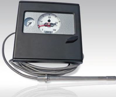
Die Messwerkregler für Druck Typ 920 und Temperatur Typ 921 sind komfortable hochgenaue pneumatische Einheitsregler für Schaltschrankeinbau oder Wandanbau. Je nach Art der Regelung können sie als P-, PI-, PD- oder PID-Regler oder als Zweipunktregler jeweils mit einstellbaren Reglerparametern arbeiten. Die Geräte zeigen den Soll und Istwert sowie den Stelldruck an und lassen die Einstellung des Sollwertes sowie die stossfreie Umschaltung von Hand- auf Automatikbetrieb zu.
