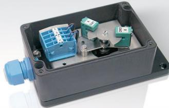
Zur Signalisierung von Zwischen- oder Endlagen kann die Signalbox Typ 827S eingesetzt werden. Sie wird nach NAMUR an die Antriebspfeiler angebaut und greift über den patentierten spielfreien ARCAPLUG®-Hubabgriff den Ventilhub ab. Maximal drei induktive Schlitzinitiatoren werden durch einstellbare Schaltscheiben angesteuert und signalisieren so die aktuelle Lage des Ventils.
